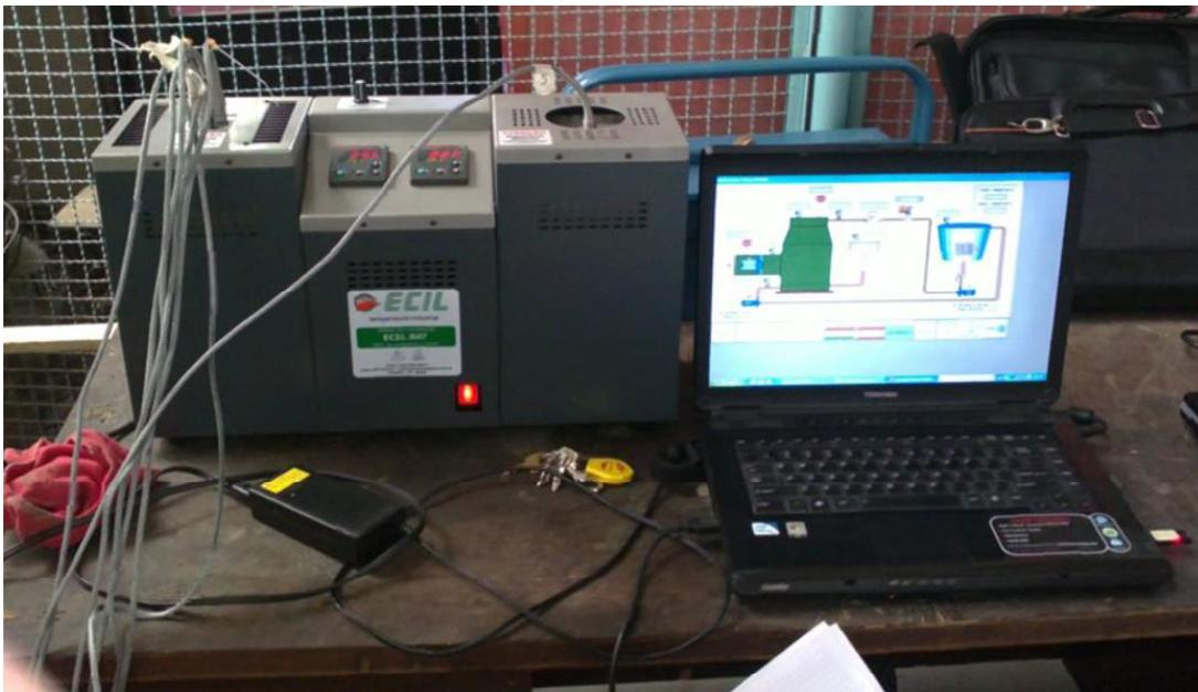
**Figura 5.** Forno para calibração dos termopares.
