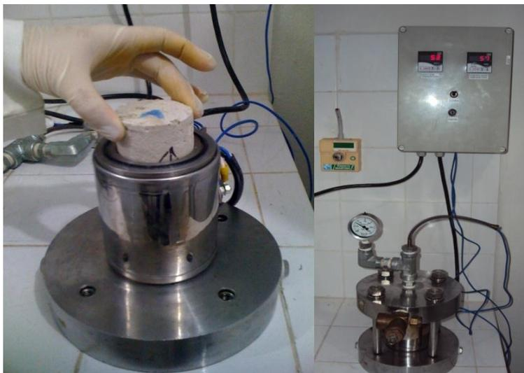
**Figura 3.** Célula de aço inoxidável para altas pressões com sistema de controle de temperatura e medição de pressão.
