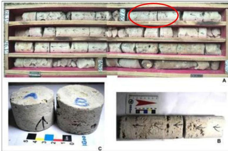
**Figura 2.** (A) Caixa com testemunho do poço; (B) Foto de pedaço do testemunho; (C) aspecto dos corpos de teste, com aproximadamente 5cm de diâmetro e 5cm de altura.
