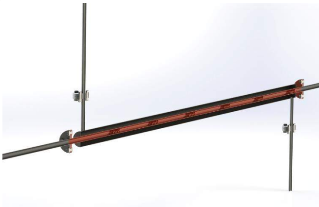
Figura 2. Modelo de trocador de calor de tubo duplo utilizado na simulação
