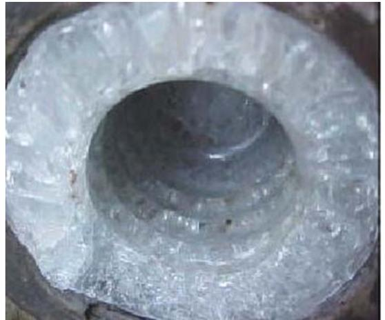
Figura 2. (a) Imagem de um isolador de vidro quebrado. (b) Imagem do interior de um isolador de vidro quebrado, após a retirada do pino metálico.
