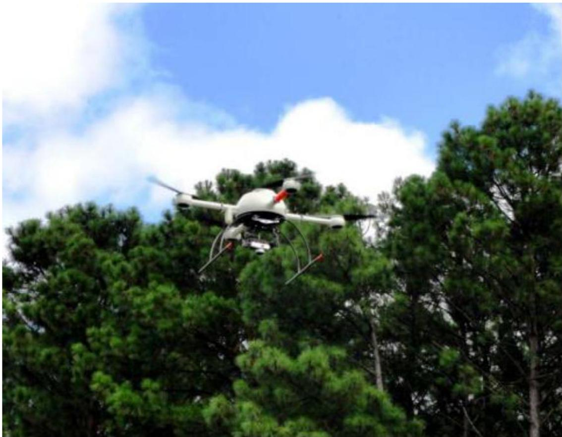
**Figura 5.** Microdrone MD4-1000 com a câmera Olympus Pen E-P1 acoplada. (Fonte: Favarin, 2013)
